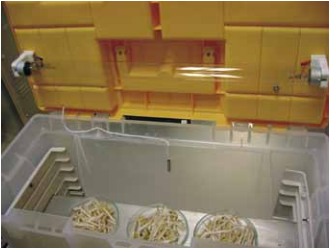
Figura 5. Muestras colocadas en la cámara germicida. Las irradiaciones y el conteo de bacterias por métodos químicos se hicieron en las muestras de los extremos, dónde la irradiación es homogénea.
