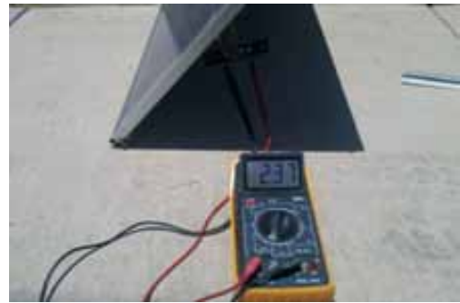
Figura 8. Prueba de corriente ( I_{sc} ) Elevación de 44° con un resultado de 2.37 A
