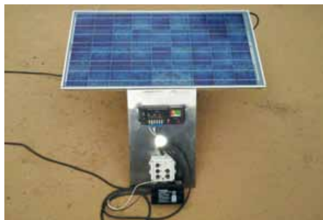
Figura 13. Sistema fotovoltaico de iluminación solar.
