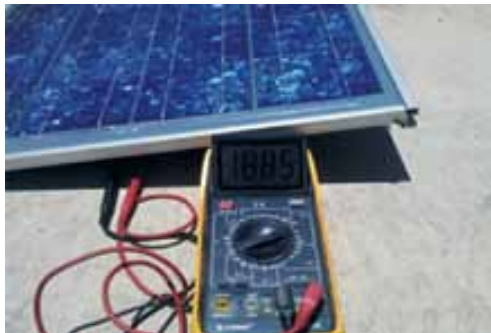
Figura 7. Prueba de voltaje ( V_{oc} ) Elevación de 10° con un resultado de 18.85 V
