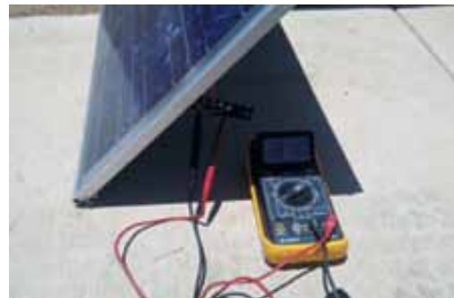
Figura 9. Prueba de voltaje ( V_{oc} ) Elevación de 44° con un resultado de 18.70 V
