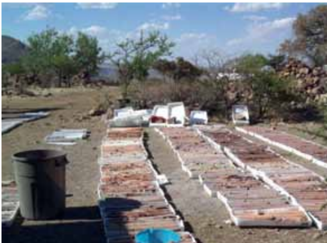
Figura 5. Núcleos de roca obtenidos durante la barrenación, éstos se colocan de manera ordenada para su análisis.
